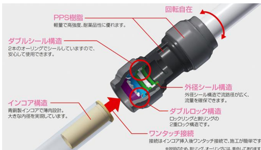
図1. ダブルロックジョイント「Revos」の構造
