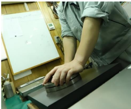
手作業によるラップ加工
