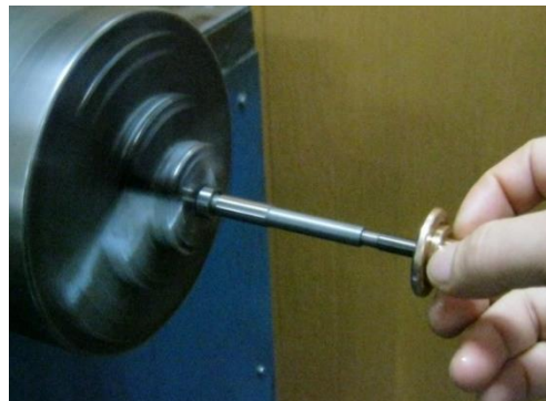
手作業による精密送りねじの摺り合せ加工
